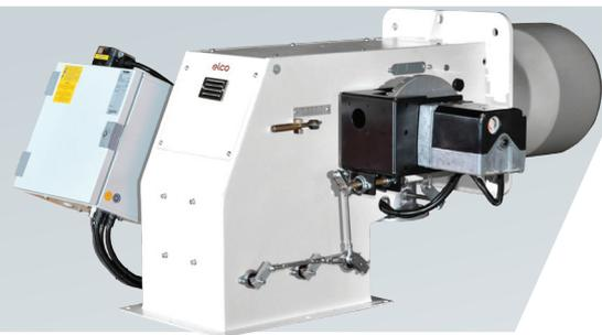
Gracias a la flexibilidad extrema y a la facilidad de uso de los quemadores D-TRON, estos resultan aptos para todo tipo de instalación de 230 kW a 34 MW. La configuración del bloque de terminales se suministra en la versión estándar, mientras que bajo petición hay disponibles versiones con el panel de control integrado. Las versiones aptas para el funcionamiento con aire de combustión precalentado a hasta 200 °C pueden usarse para alcanzar mayores valores de eficiencia.
