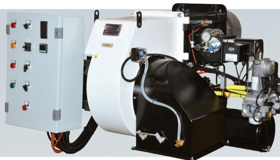
Los quemadores GHO-TRON están disponibles en dos etapas (GHO-TRON 3) y en versión progresiva con servomotor eléctrico y doble leva mecánica ajustable que permite realizar el afinado del gas de aire/fuel pesado (versiones de hasta 17 MW). Hay disponibles, bajo petición, versiones configuradas y especiales según el tipo de aplicación y las características del fuel.
